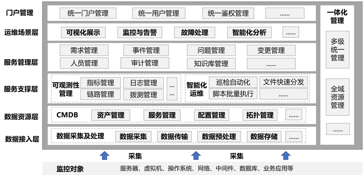
图2 政务云智能运维能力功能架构图
